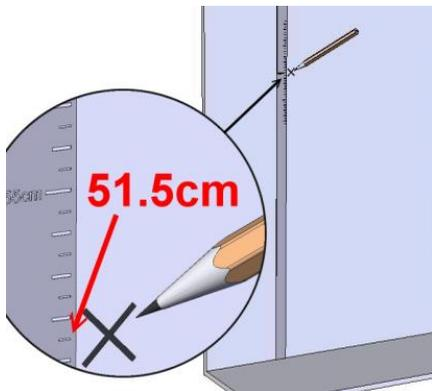
2. Allungare completamente l'altimetro e contrassegnare la posizione del foro superiore
