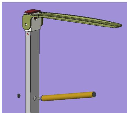
3. Forare sopra i segni realizzati in precedenza e fissare l'altimetro alla parete.
