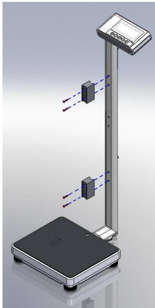
2. Fissare l'altimetro al blocco di fissaggio utilizzando le viti a croce.
